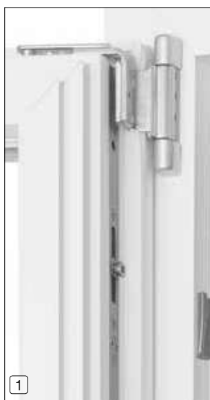
1 Cerniera superiore con chiusura angolare realizzata con incontro e nottolino a fungo regolabile.
